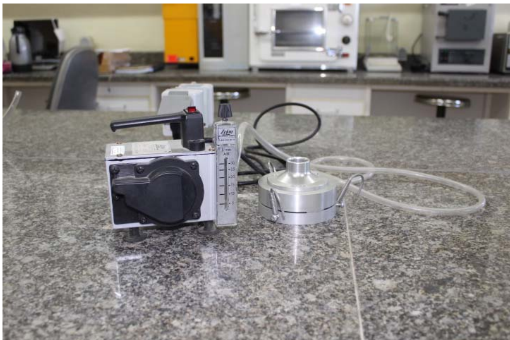
۳- نمونه بردار میکروبی (ایمپکتور تک مرحله ای)
