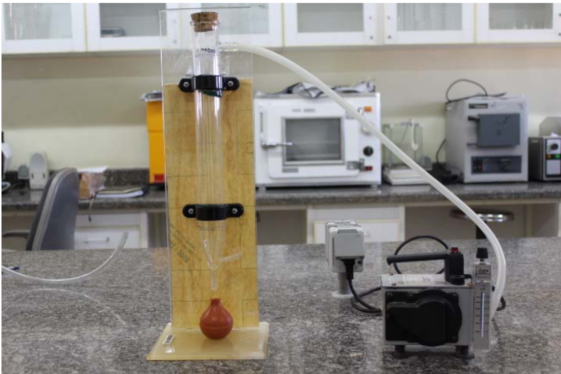
۹- بورت حباب صابون (پیستون بدون اصطکاک)
